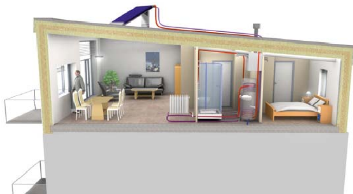
Figur 32: Prinsippskisse av forenklet varmesystem med solfangerer for en leilighet i Løvåshagen, kilde: Gemini.
